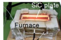
1000°Cに加熱したセラミック板に対して超音波検査を実施
