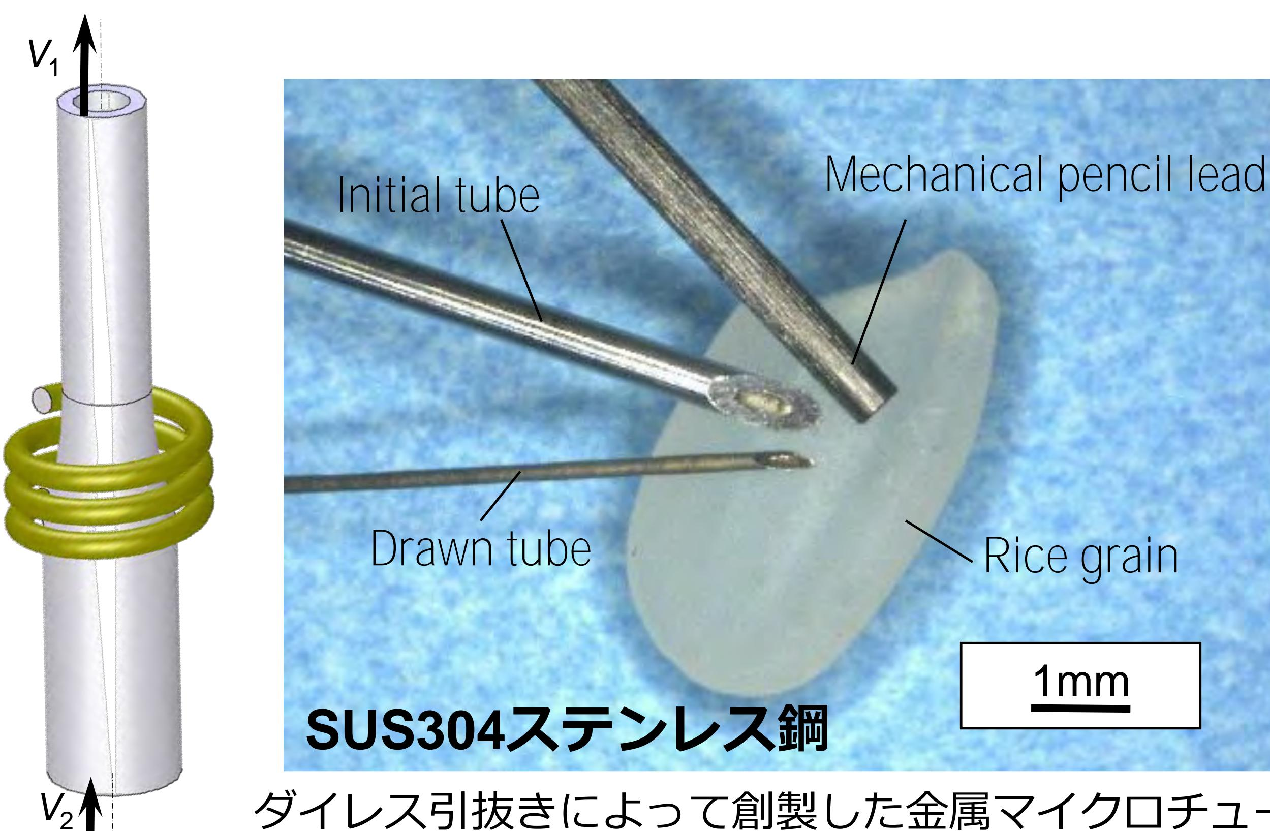
ダイレス引抜きによって創製した金属マイクロチューブ
