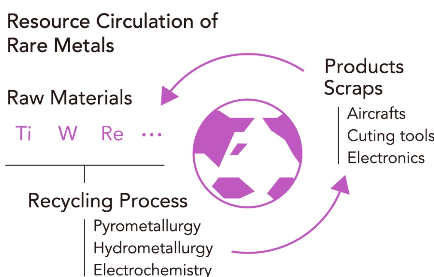
構造材として需要の増大が見込まれるチタン、工具材料として欠かすことができないタンクスチンとコバルト、ニッケル基超合金に使われるレニウム、自動車排ガス浄化触媒に含まれる白金族金属などに注目し、新規な高効率かつ環境調和型のリサイクル技術の開発を行っています。
