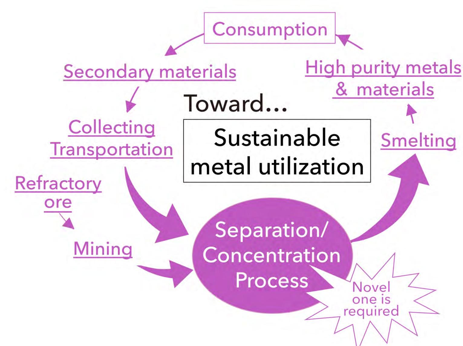
廃棄物や鉱石を固体のままで分離濃縮する省エネルギー型プロセスの研究開発を行っています。このような固体分離濃縮技術は、高温や薬剤で溶かして高純度の金属を生産するプロセスの「前処理」あるいは「中間処理」に位置しています。
