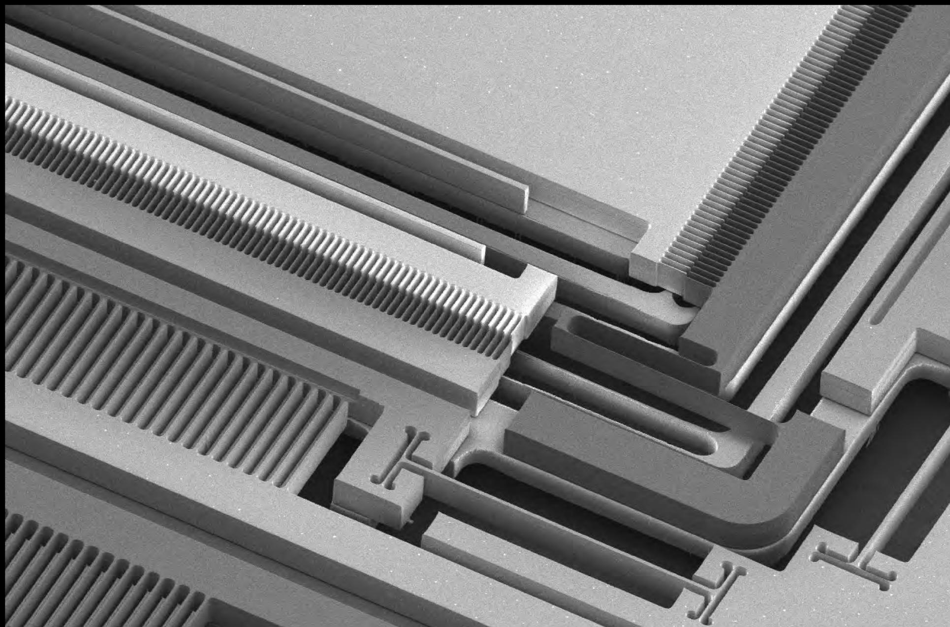
半導体微細加工技術を用いたMEMSなセンサ、アクチュエータ、エネルギーハーベスタを研究しています。材料、プロセス、デバイス、システムからIoTサービスまで、技術レイヤーを俯瞰したエンジニアリング・センスを磨きたい人は、学生・社会人を問わず歓迎します。
