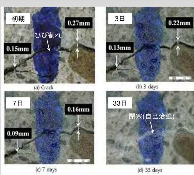
自己治癒コンクリートにおける自己治癒プロセス性能評価手法の開発
