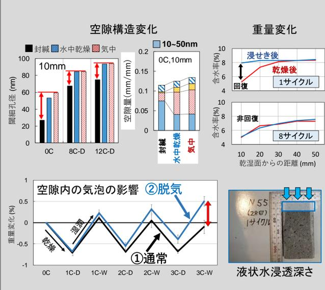
乾湿繰り返しによる空隙変化と液状水浸透挙動
