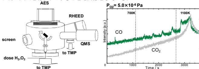
表面分析のための超高真空槽。背圧は10<sup>-9</sup> Paに達する。RHEED, AES, QMSとガスクラッキング機構により表面の構造、化学結合種、脱離種の計測が可能となる。
