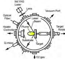
Nd:YAGレーザー源を有するパルスレーザー蒸着装置。意図しない不純物の混入を極力避けるため、10<sup>-7</sup>Paの背圧を維持している。
