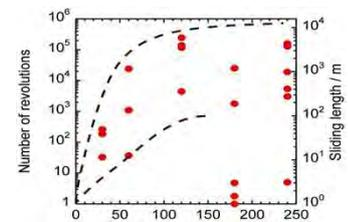
SSRD法を用いて、Al合金上に堆積したDLC膜のボールオンディスク試験結果。SSRD時間の増加に伴い、耐久性が向上していることがわかる。
