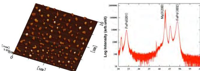
Feシード層およびAu凝集層の堆積により、単結晶MgO基板上に形成された数十nmのFePdナノドット薄膜。AFM像とXRDパターンから均質なナノドット構造と結晶配向性が確認できる。
