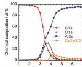
DLC膜(左)とAl合金基材(右)との界面近傍のXPS測定結果。SSRD法により、界面近傍にAl/C混合層が形成されていることがわかる。
