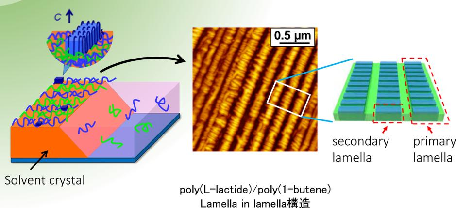
水と油が分かれるように、一般に異種ポリマーのブレンドは規則性の低い相分離構造を形成します。我々は、指向的な相分離過程を途中で凍結することで、ポリマーブレンドからナノメートルオーダーの規則的な周期構造を形成させる手法を開発しました。
