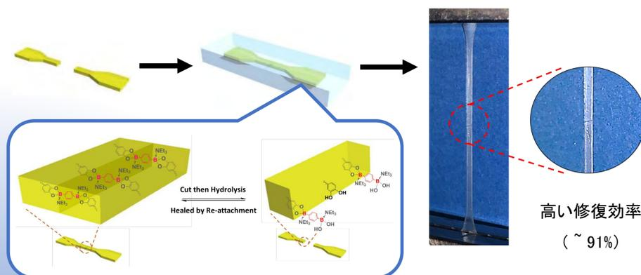
我々の身近に多く存在する水分をトリガーとして自己修復する材料では、一般的に親水的な動的結合により材料が水を吸収してしまい特性が低下する問題がありました。我々はボロン酸エステルという疎水的な動的結合を用いて、海水中で安定的に自己修復可能なエラストマーを開発しました。
