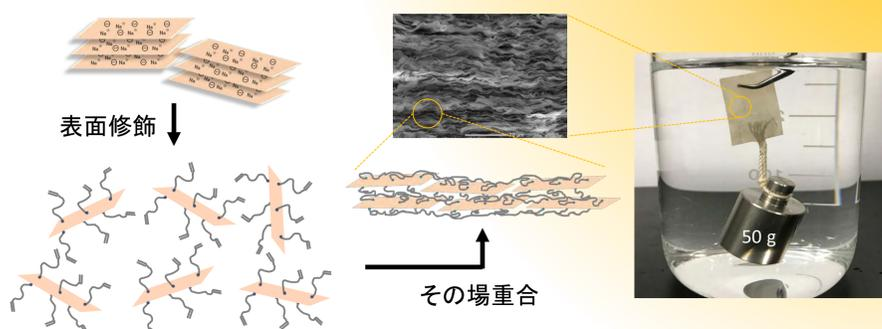
貝殻の内側に形成される真珠層は板状無機物と有機ポリマーが規則的に積層した有機/無機ナノハイブリッドであり、極めて高い剛性と低い物質透過性が特徴です。しかし、真珠層を人工的に模倣した材料は、無機物の親水性により水や湿気に弱いという欠点がありました。我々は無機物表面の疎水化とその場合重合により、高剛性かつ高耐水性な有機/無機ナノハイブリッドを開発しました。
