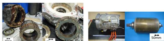
図 T社 HV駆動用と発電用モーター回転子：駆動用6.8kg、発電用2.1kg
