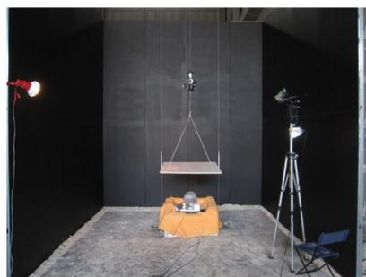
天井材落下実験による安全性評価
