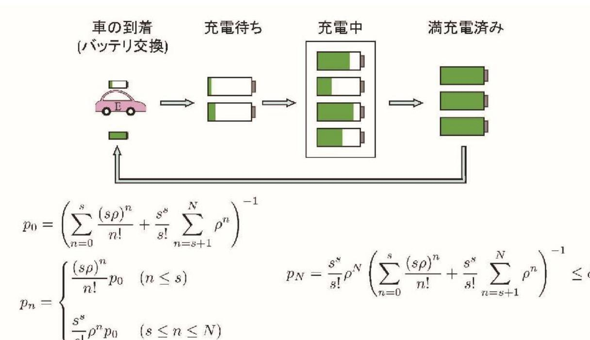
本研究では、電気自動車(EV)の支援インフラとして、バッテリー交換型ステーションを想定した上で、バッテリー在庫という観点から、その適切な運用形態を評価しています。
