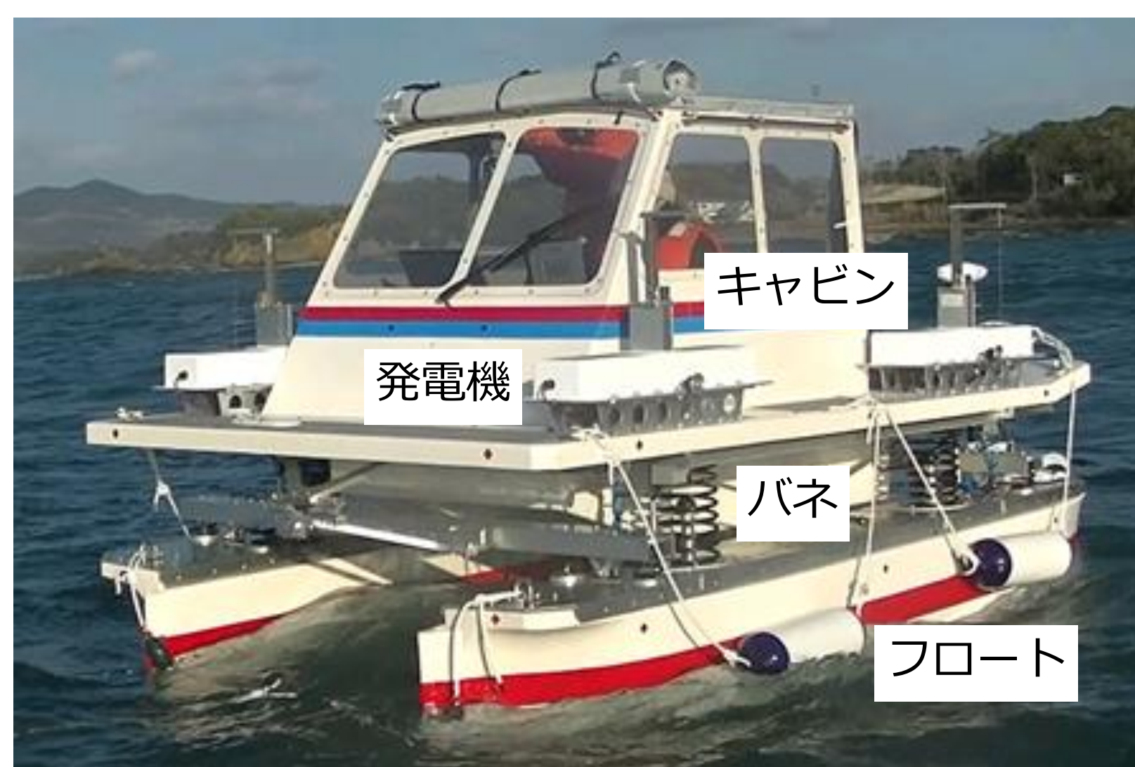
波エネルギーを吸収して乗り心地を向上した船 (WHzer7)
