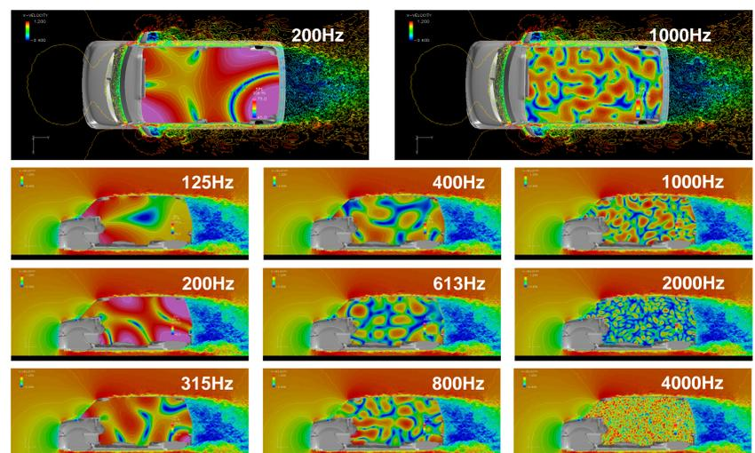
図4 車両内部の音響解析結果
