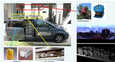
全方位カメラやレーザセンサにより交通シーンにおける周辺構造物(建物・路面)の位置・形状・光学情報を獲得
