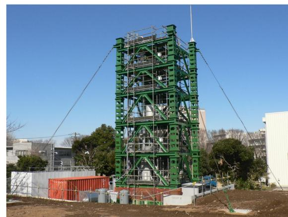
千葉実験所 大型循環流動層コールドモデル
