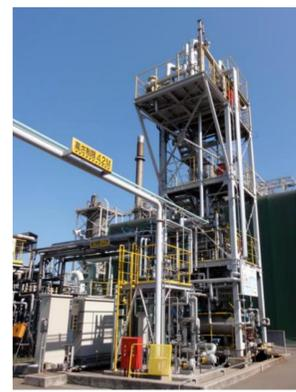
自己熱再生概念図（左）、自己熱再生実証実験蒸留装置（右）
