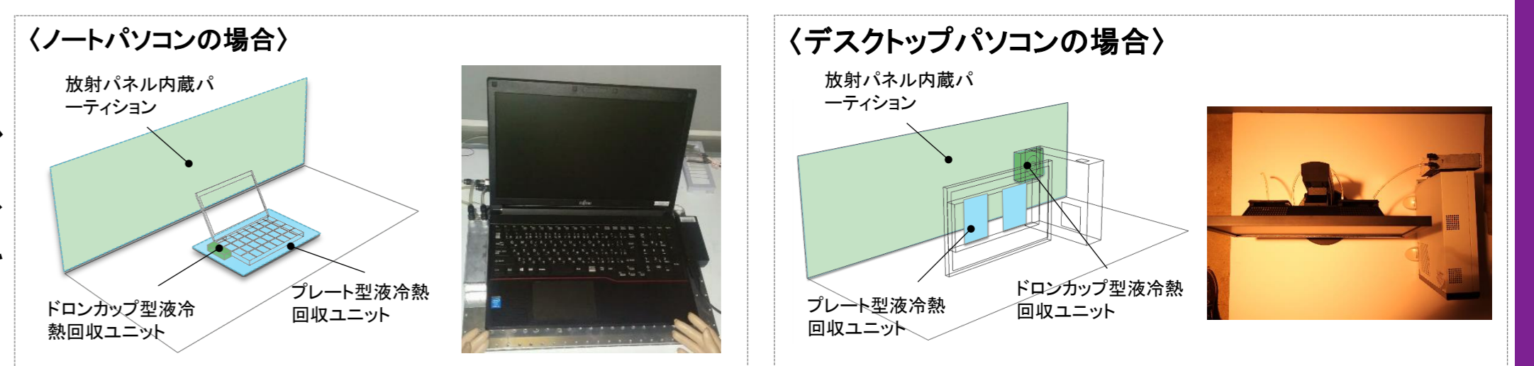
図3. 発熱機器と液冷熱回収ユニットの構成
