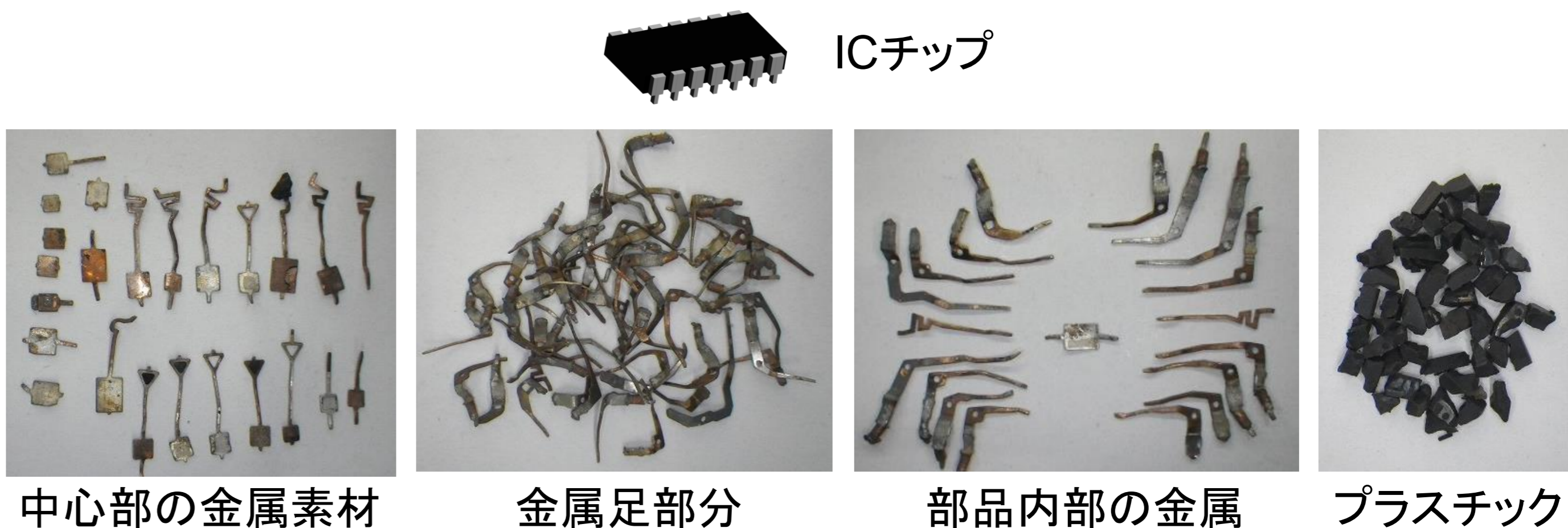
電気パルス粉碎によってICチップの単体分離された各種素材
