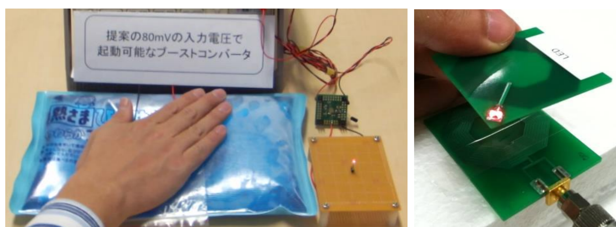
温度差発電(左)と無線給電(右)でLEDを点灯
