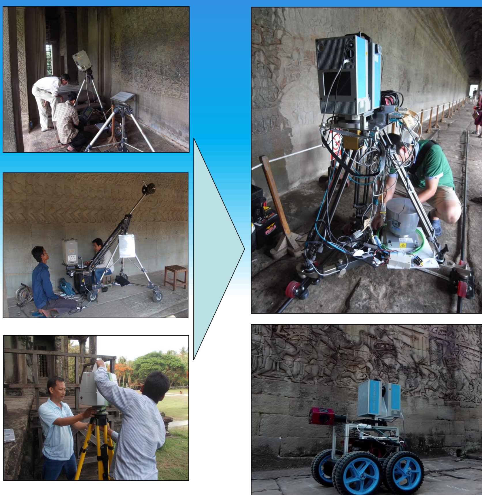
図. 現地技術者による計測風景(左列)、開発中のレール型センサー及びローバー型センサー(右列)
