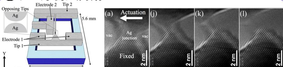
極微の滑り(隣接原子の間隔の幅 0.3nmの滑り変形)を観察
