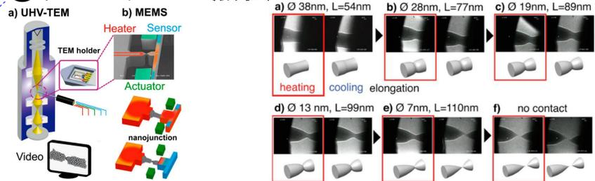
バルクの10~100倍の熱伝導率(バリスティック熱電導)を計測
