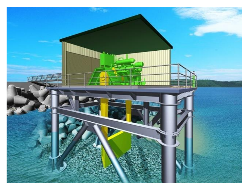
43kW 波力発電装置
