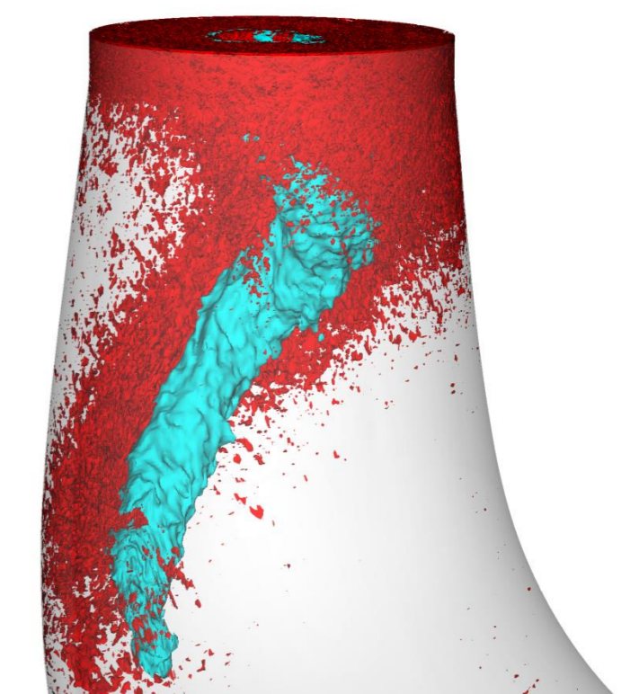
図2 ドラフトチューブ内の渦ロープ (キャビテーション数 \sigma=0.10 )
