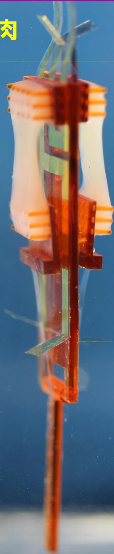
筋肉の基となる細胞(筋芽細胞)を、マイクロ加工技術で作製した駆動システム上にて3次元培養することで、生体の腕や指のように屈曲運動可能な骨格筋付きバイオリボットの開発に成功した。
