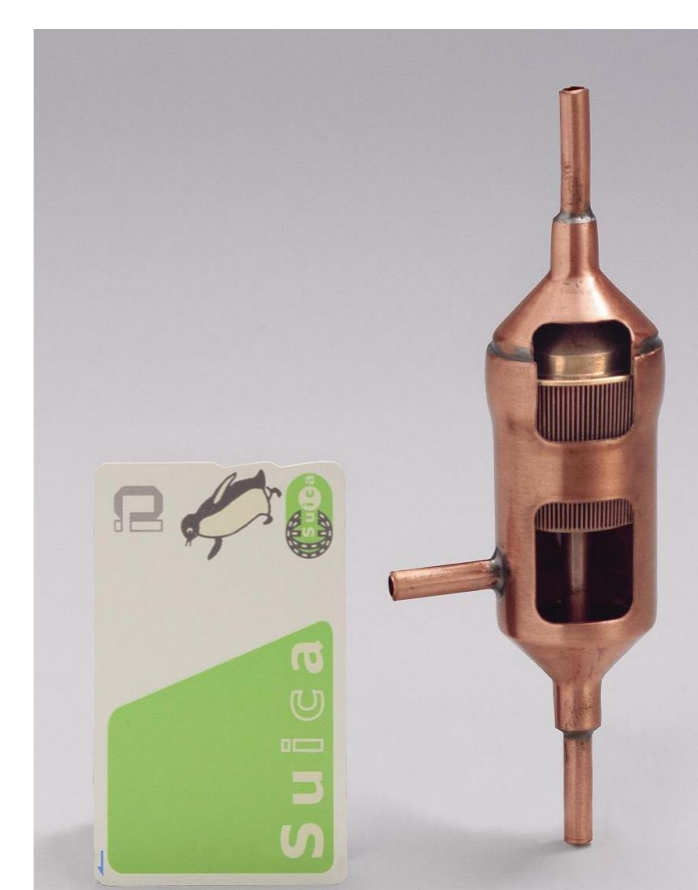
図7 表面張力利用気液分離器
