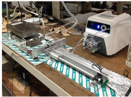
磁気熱効果を用いたエクセルギー再生実験装置
