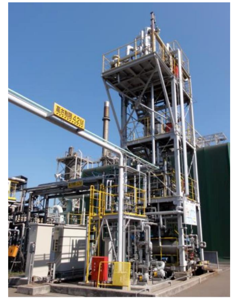
自己熱再生概念図(左)、自己熱再生実証実験蒸留装置(右) 新日鉄エンジニアリング 北九州環境技術センター内
