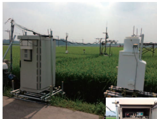
図5. つくば市真瀬にある試験水田における観測の様子。左のBoxが水蒸気同位体比分析装置(右の写真はその中身)で右側は自動降水採取装置。
