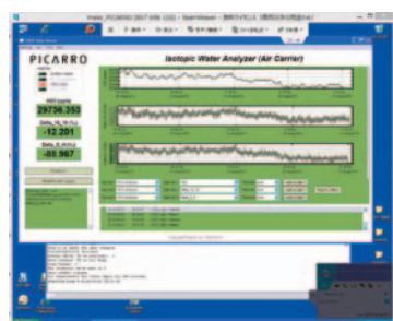
図4. リモートコントロールによる水蒸気同位体比のリアルタイムモニタリングの様子
