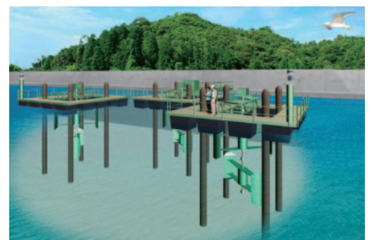
鉛直軸水車潮流発電システムの概念図
