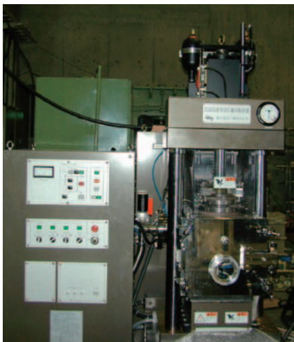
高ひずみ速度付与試験設備
