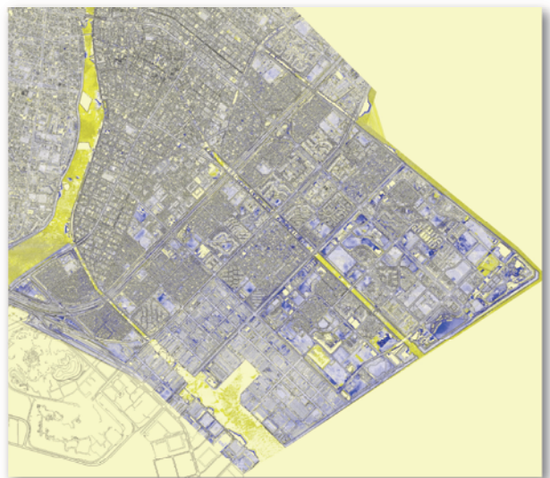
航空レーザ計測による浦安市の液状化沈下マップ (青色の濃さが沈下の大きさを示す)
