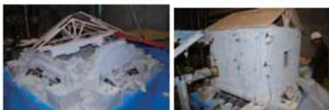
無補強：完全崩壊 PP-band補強：崩壊せず
