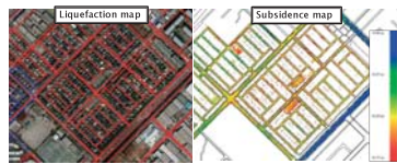
航空レーザによる液状化地盤沈下マップ
