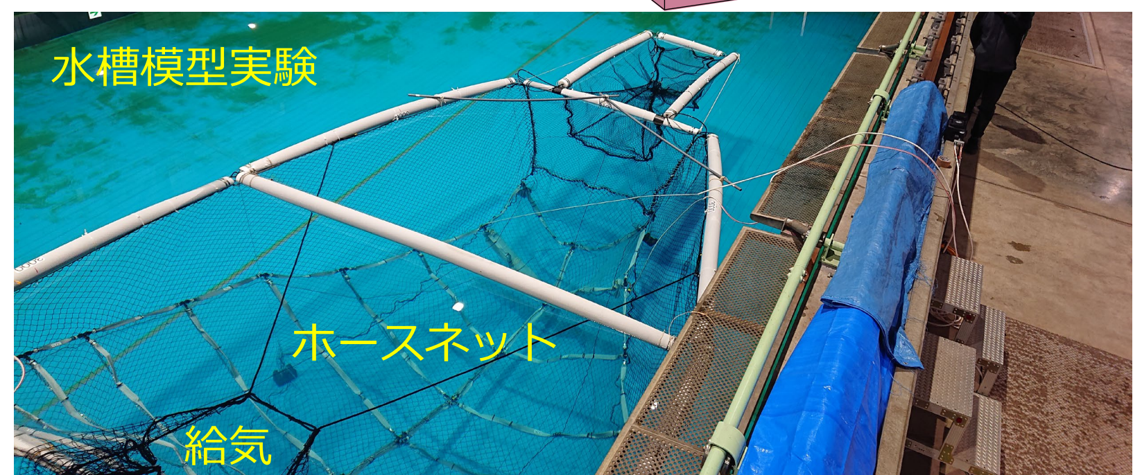
定置漁業自動魚群誘導化システム 揚網作業の省人・省力化を目指しています。
