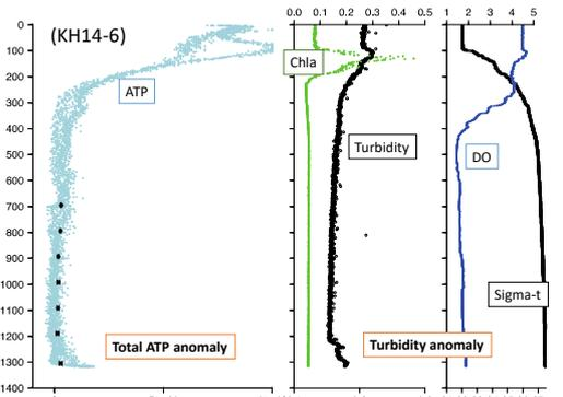
マリアナトラフ Seamont-Xにおける鉛直ATP計測の結果。ATP定量分析装置をCTDに搭載して計測
