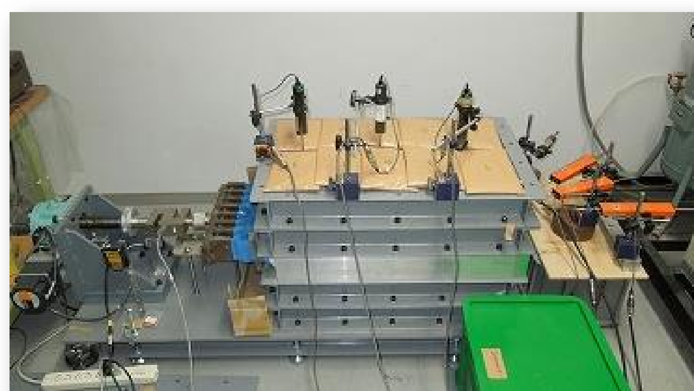
液状化発生前後の地盤強度の変化と中空供試体による液状化実験
