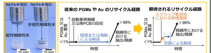
無電解めっき処理や FeCl<sub>3</sub> 蒸気による化学処理によって、スクラップ中の貴金属が含まれる箇所に選択的に磁性を付与し、磁力選別技術を用いて容易に貴金属を濃縮可能な技術を開発しています。従来スクラップの集荷地から製錬所まで海路や陸路で輸送していたところを、本技術によって、空路での輸送を可能とすることで時間的コストの大幅削減を図ります。これにより、世界中からスクラップが日本に集まり処理される新しいビジネススキームの構築が期待されます。
