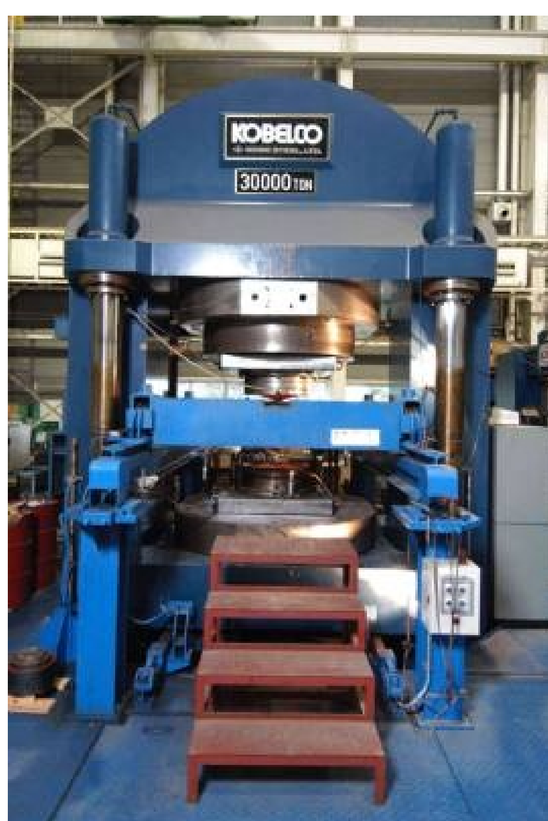
ベルト型高圧発生装置・高圧合成環境の現状・窒化ホウ素結晶による多様な機能発現 Belt-type high pressure apparatus, synthesis conditions, and variety functions of boron nitride crystals.
