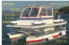
Wave Harmonizer (山口県徳島湾・神奈川県平塚沖) 小型船で波エネルギーを収穫して乗り心地を向上しました。相似則を考慮し、魚の衝突、行動を明らかにしました。
