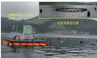
可変深度型生簀と自動操網システム (宮城県女川町) 任意の深度に設置できる可変深度型生簀を開発しました。
