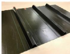
CFRP製補強パネル供試体
