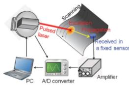
レーザー超音波可視化検査装置 (LUVI-CP, つくばテクノロジ (株))
