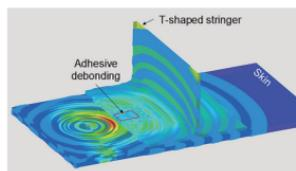
CFRP製スキンスリンガ接着構造における剥がれ損傷の検知
