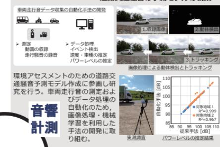
環境アセスメントのための道路交通騒音予測モデル作成に参画し研究を行う。車両走行音の測定およびデータ処理の自動化のため、画像処理・機械学習を利用した手法の開発に取り組む。
