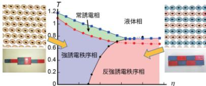
強誘電-反強誘電相転移およびそれに伴う電気力学応答を制御可能なモデルを提案
