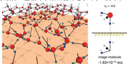
基板表面における水分子のふるまいを分子動力学シミュレーションで計算
