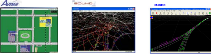
AVENUE: 街路交通シミュレータ 渋滞緩和策評価などに使用 SOUND: ネットワーク交通シミュレータ 数十km範囲の広域を対象 KAKUMO: ミクロ交通シミュレータ TSとDSを接続
