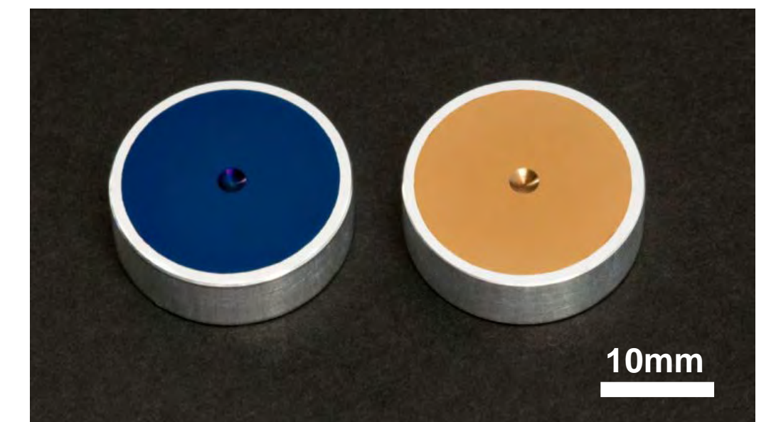
DLCがコーティングされたアルミ合金部材。色の違いは膜厚に依存した干渉により生じている。これはDLCが可視光領域で透明であることを示している。
