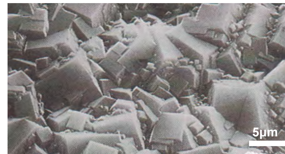
多結晶ダイヤモンド膜。四角い(100)面が観察できる。このように、晶癖が明確に現れているため、表面の凹凸が非常に大きい。
