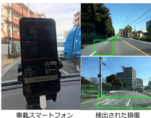
車載スマートフォン 検出された損傷
