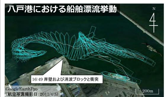
500 ton未満の船舶の衝突が生じたとしても、崩壊等の著しい不具合が生じる可能性は低い
