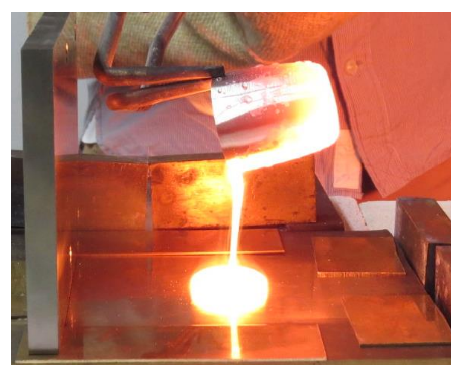
模擬廃棄物固化ホウケイ酸塩ガラスの溶融
