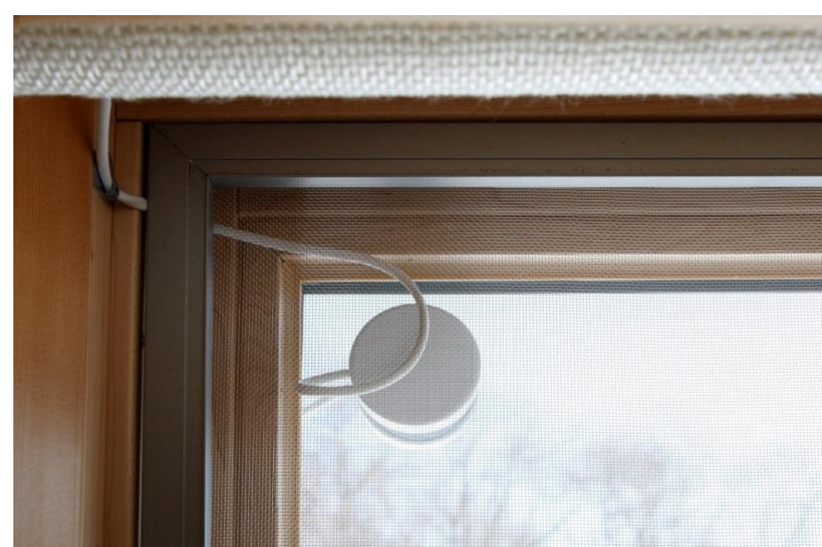
Window thermal sensors 窓面の温度計
