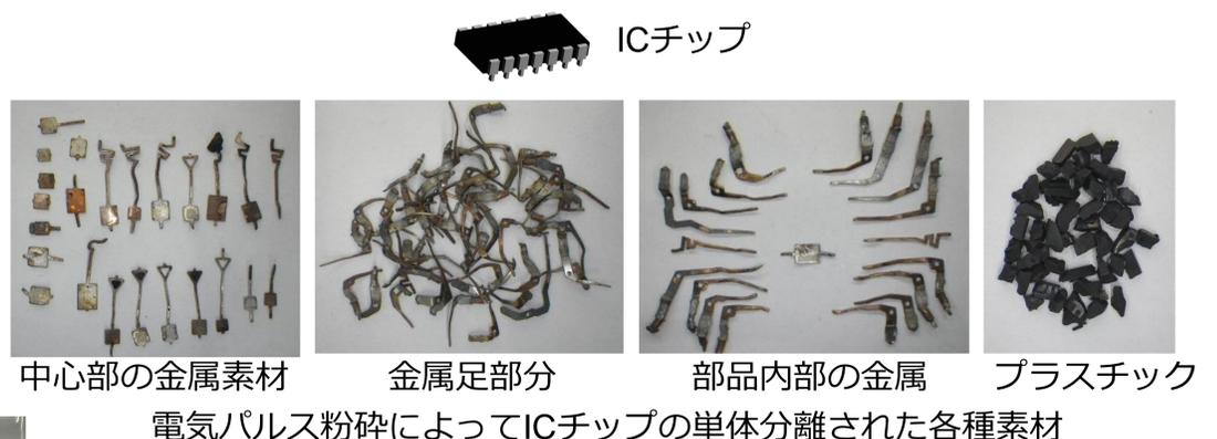
電気パルス粉碎によってICチップの単体分離された各種素材
