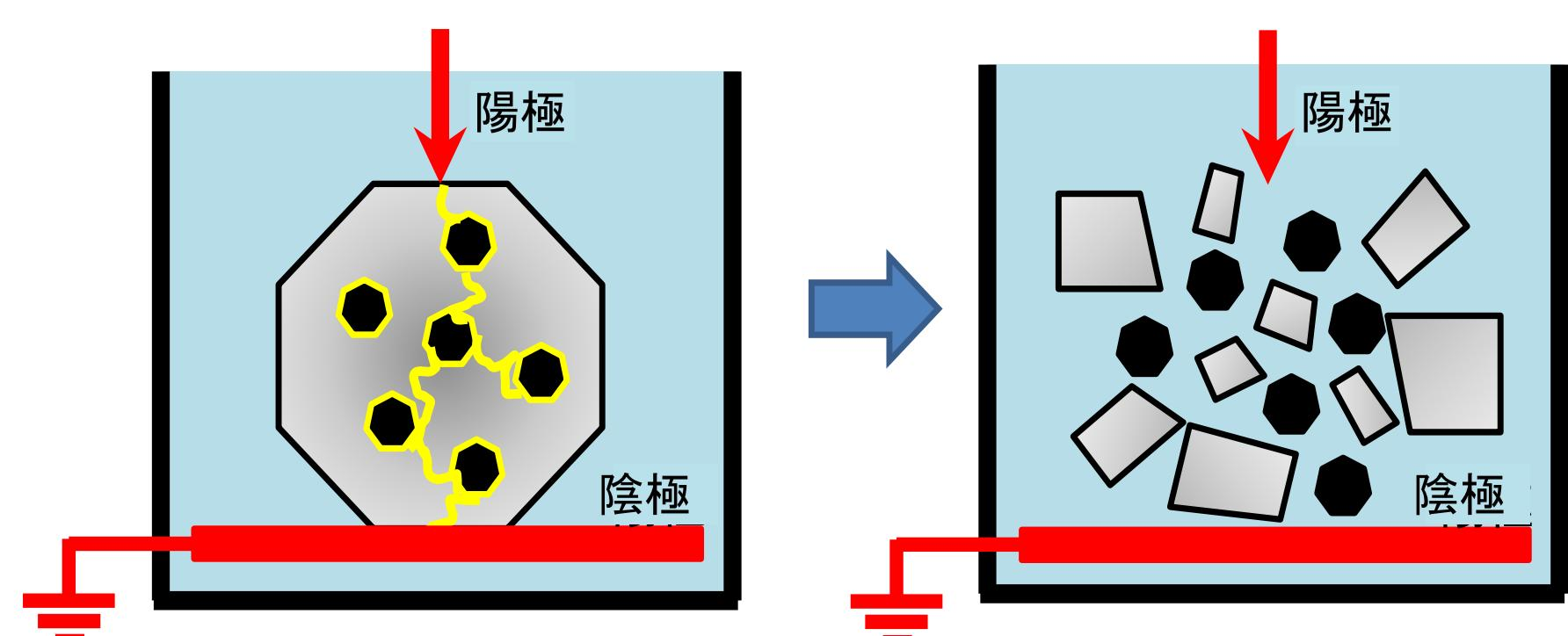
電気パルス粉碎の破壊概念図
