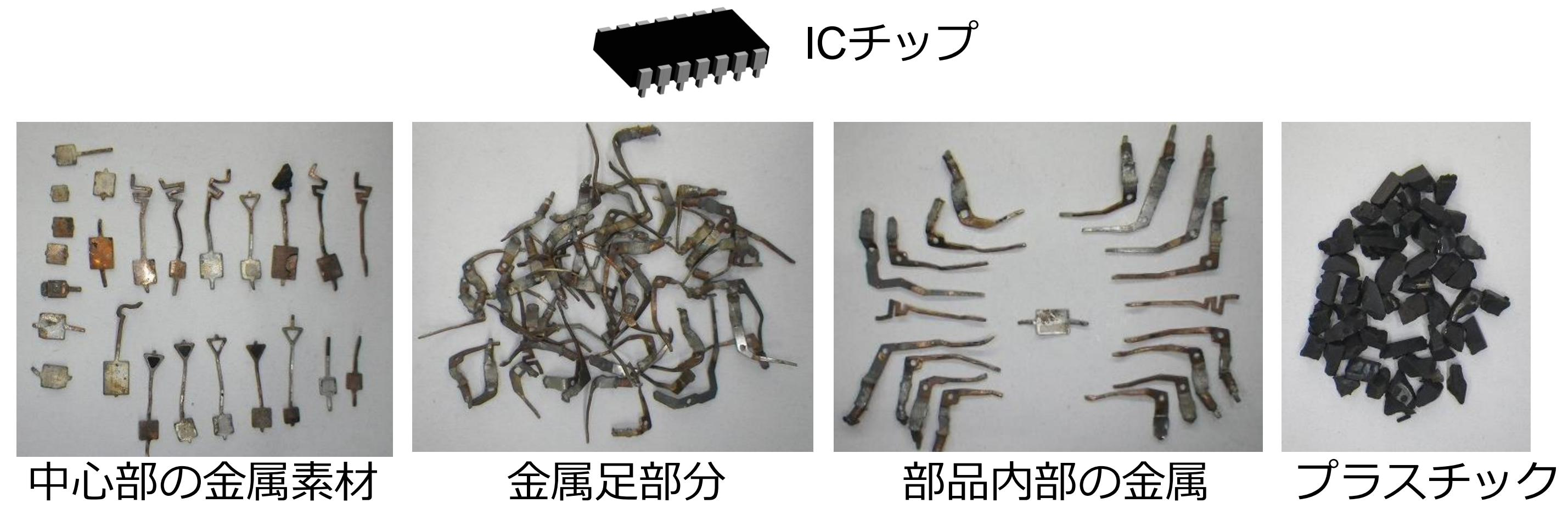
電気パルス粉碎によってICチップの単体分離された各種素材
