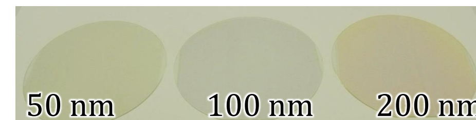
φ100 mm基板上的IGZO薄膜ミストデポジションにて作製
