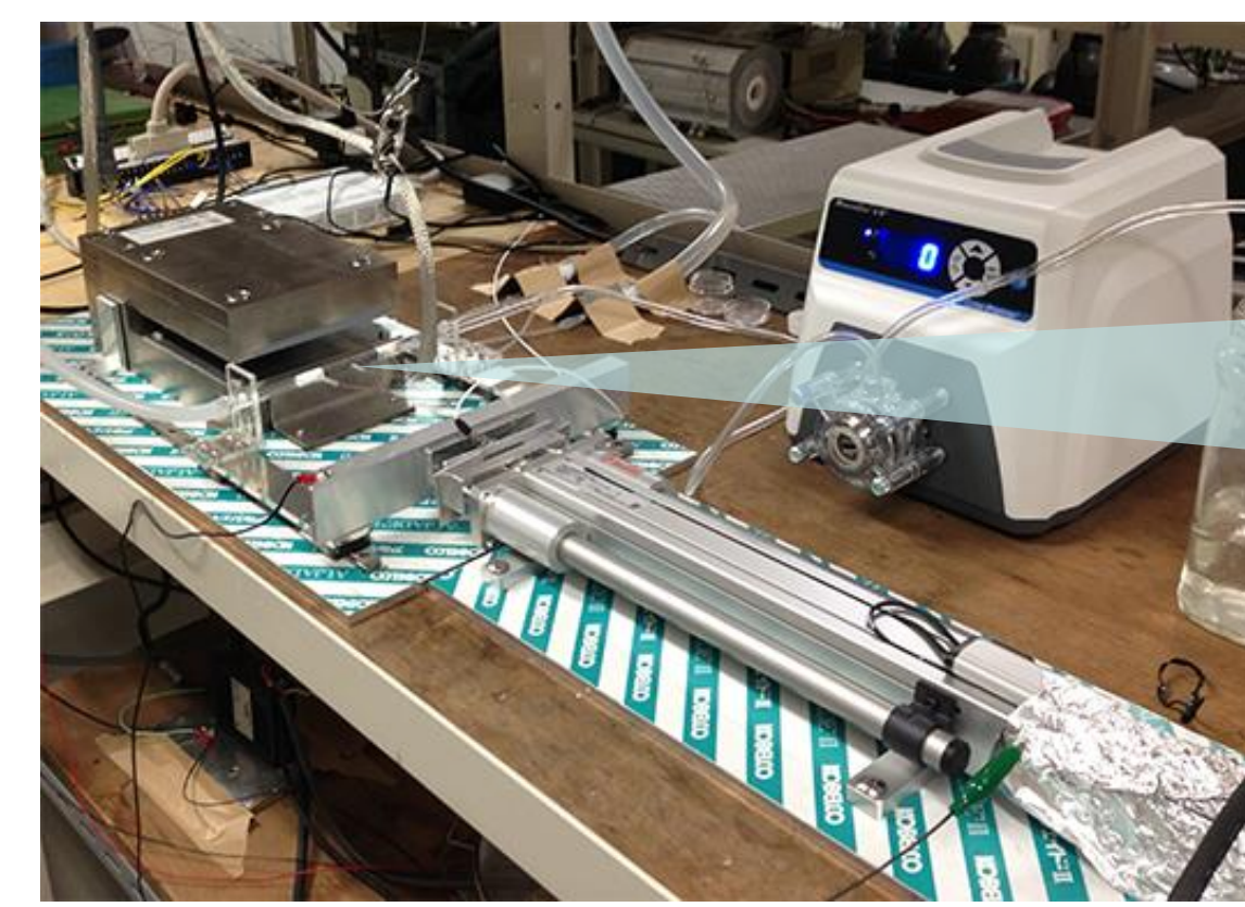
磁気熱量効果を用いたエクセルギー再生実験装置
