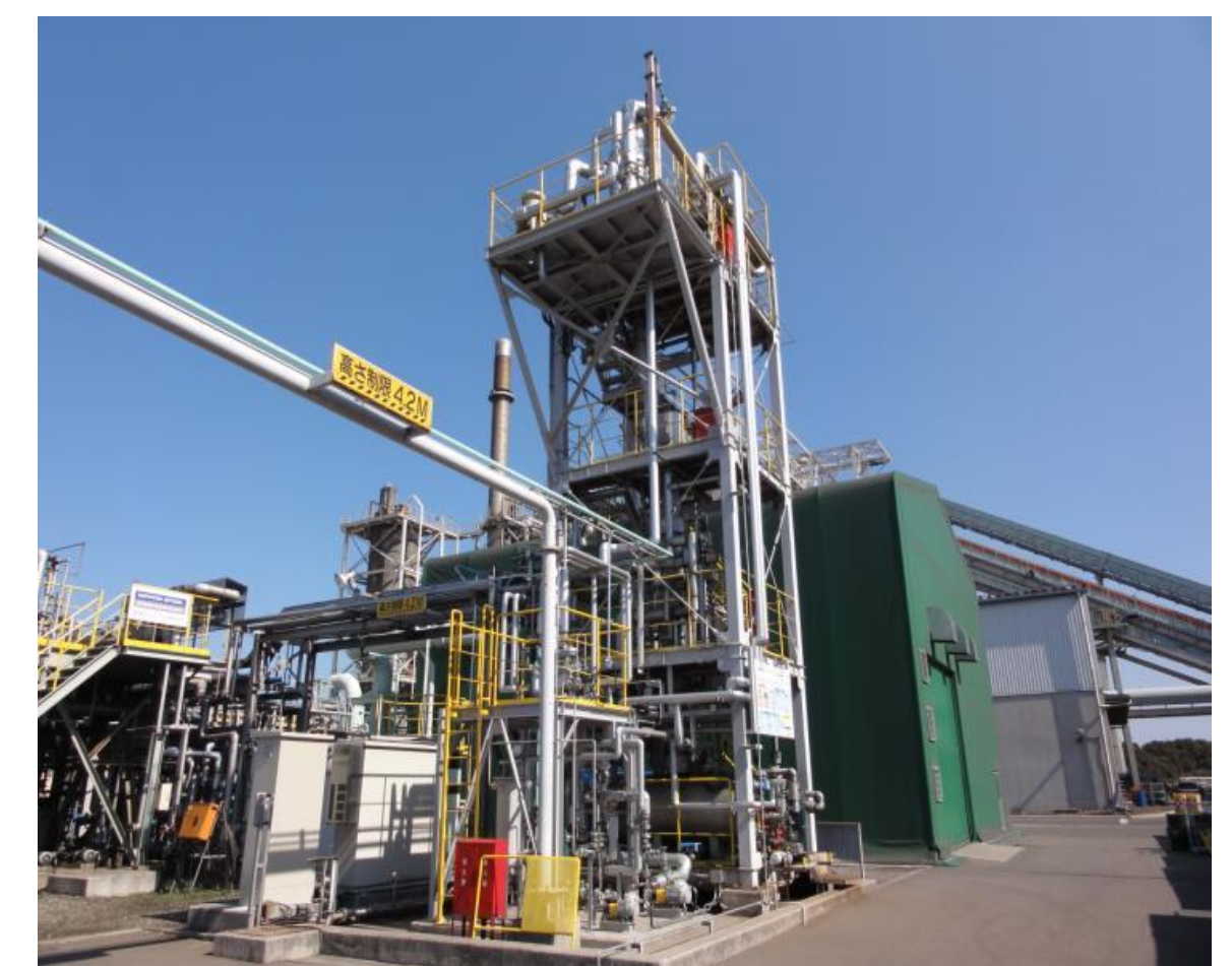
バイオエタノール製造用自己熱再生型蒸留装置 新日鉄住金エンジニアリング株式会社 北九州環境技術センター
