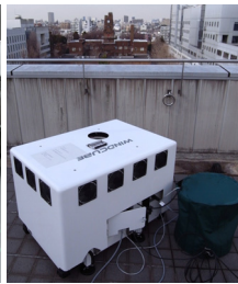
■ドップラーライダーを用いた風速実測
