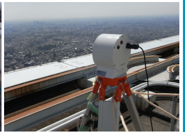
■シンクロメータを用いた都市域の顕熱フラックス実測
