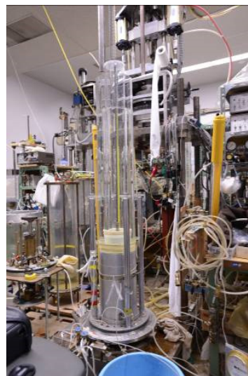
図2. 水中落下法による分級供試体の作製状況
